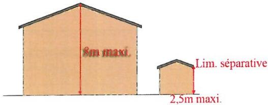
Exemple d'une construction détachée du bâtiment principal qui s'appuie sur une limite séparative.
